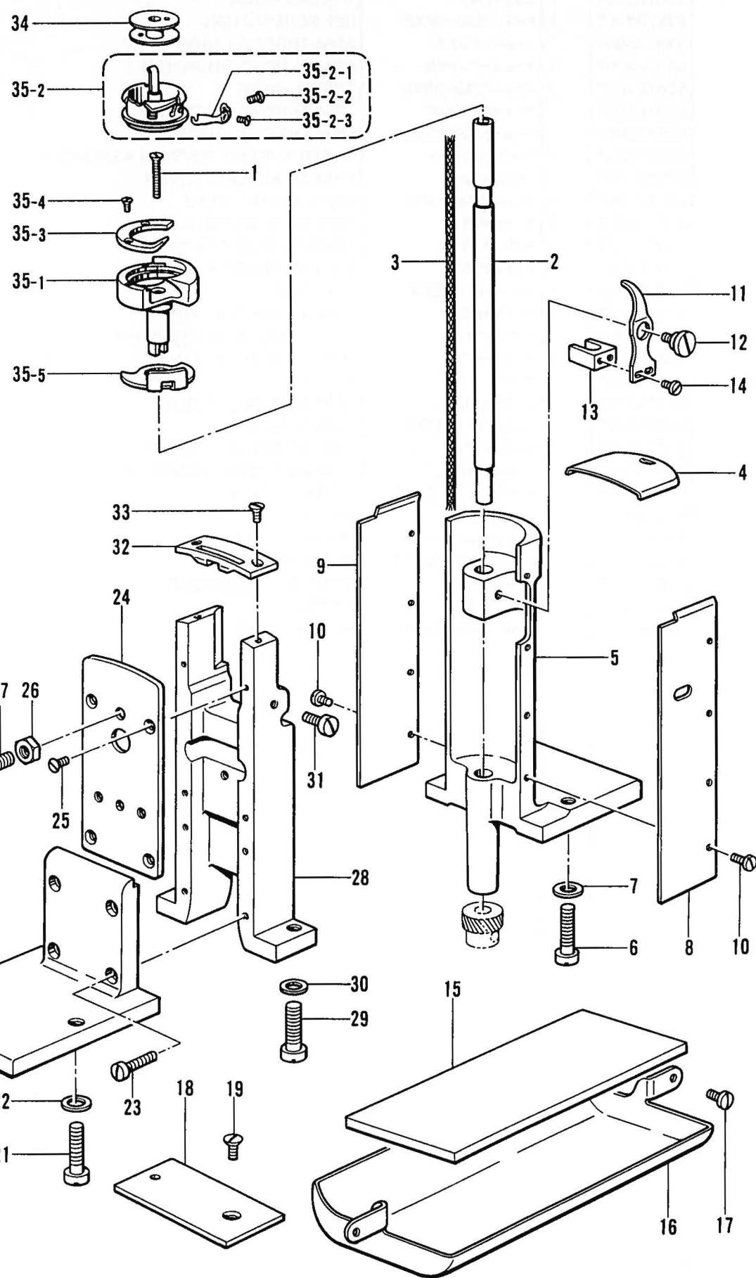
J1. カマ関係 /Rotary hook mechanism/Greifervorrichtung/
