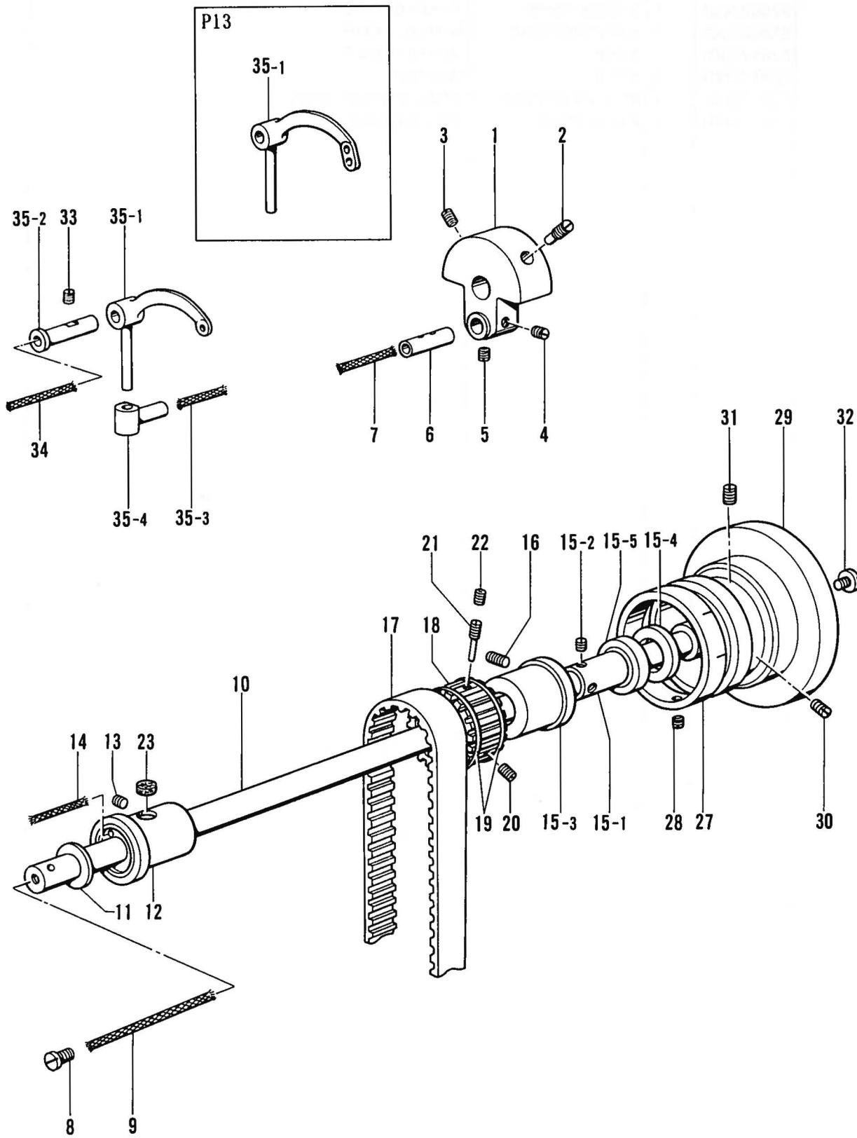
B. 上軸・天ビン関係 / Upper shaft and thread take-up mechanism / Obere Welle und Fadenabnahmeverrichtung /
