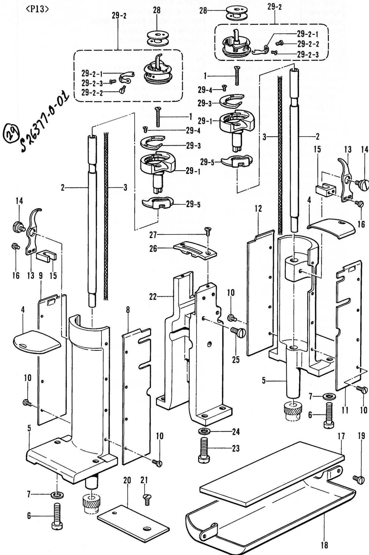
J2. カマ関係 /Rotary hook mechanism/Greifervorrichtung/
