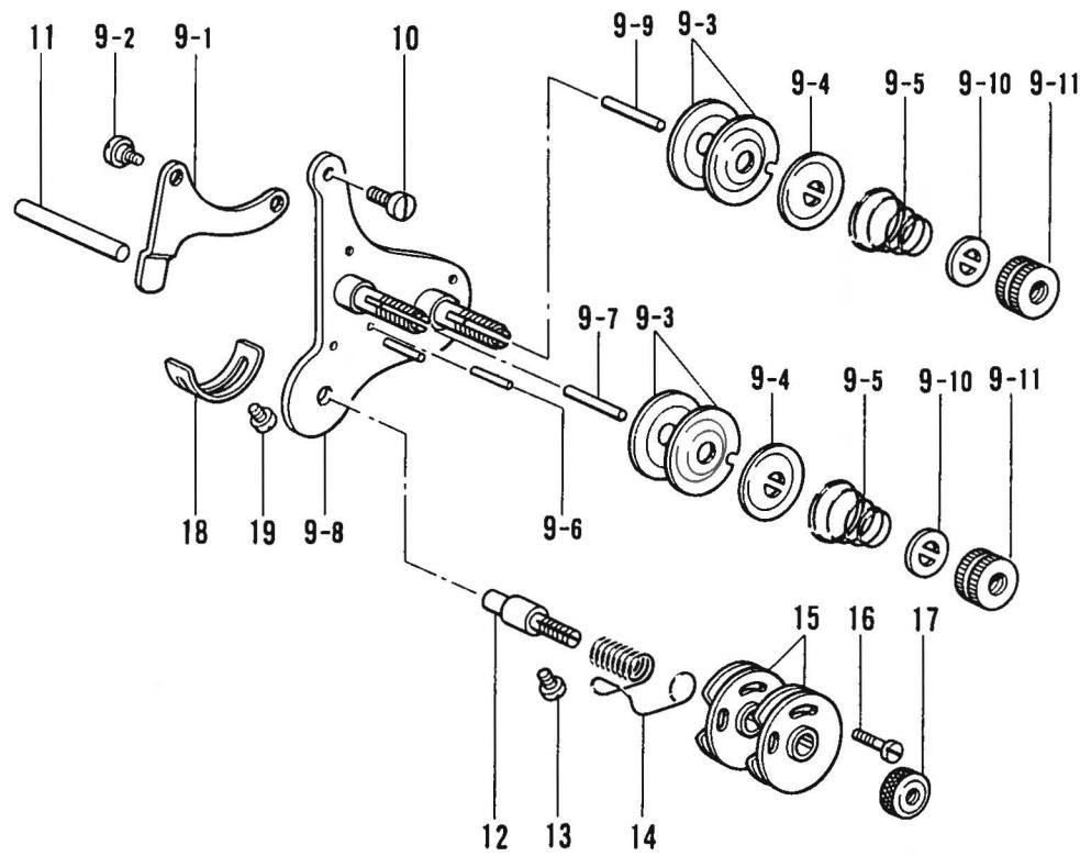
H2. 糸調子関係 /Thread tension/Faderspannung/
